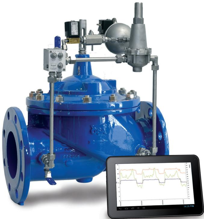
La valvola automatica con funzionamento idraulico CSA XLC 310/410-T riduce e stabilizza il valore della pressione di valle in base alle variazioni di portata, seguendo delle curve appositamente create e modificabili, grazie ad impulsi forniti da un programmatore CSA o da un PLC esistente, a batteria o con controllo remoto via web mediante un'apposita interfaccia.
